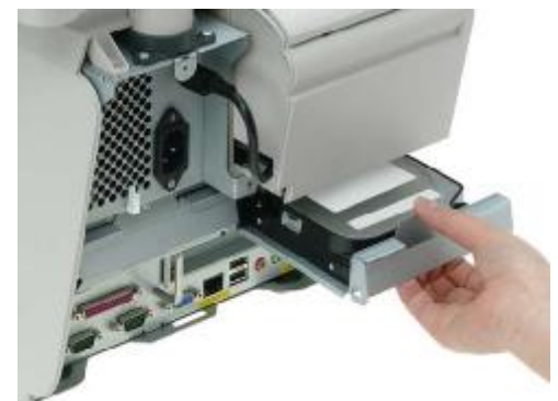
Die Festplatten sind blitzschnell erreichbar und sichern Ihre wertvollen Daten per RAID Controller.
